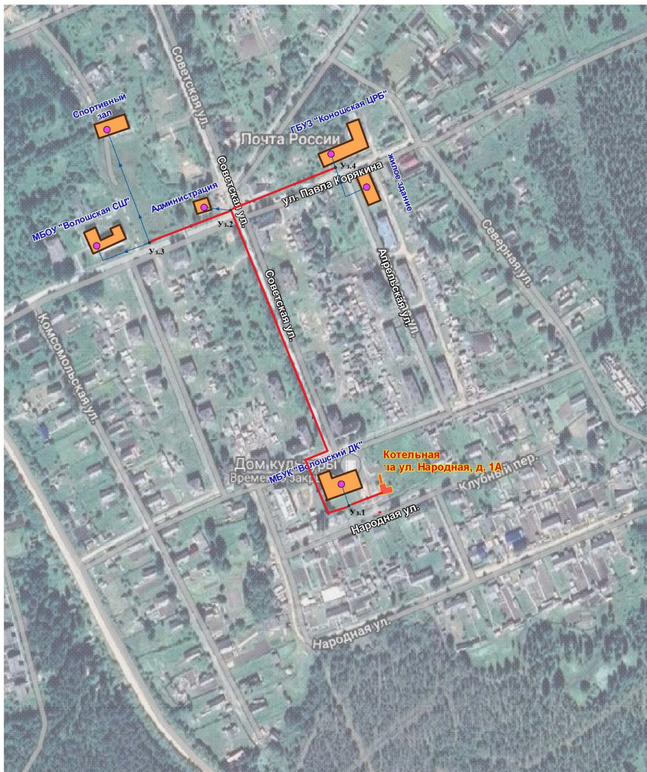
Рисунок 2. – Схема пути для расчёта вероятности безотказной работы тепловых сетей в зоне действия котельной на ул. Народная, д. 1А
